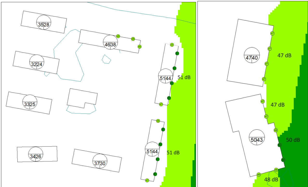
Kuva 4. Asuinrakennuksien julkisivuihin kohdistuvat suurimmat melun keskiäänitasot (dB(A) päiväaikana (klo 7–22) ennustetilanteessa vuonna 2050. Vasemmalla esitetty tarkastelualueen pohjoisosan rakennukset, oikealla tarkastelualueen eteläosan laajennusvarauksen rakennukset.
