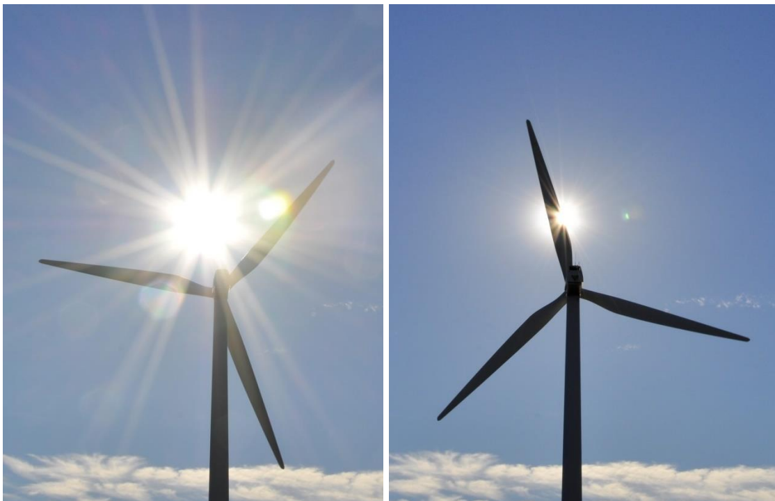
Kuva 17-21. Tuulivoimaloiden lavat aiheuttavat pyöriessään vilkkumista ja varjon välkkymistä aurinkoisella säällä.
