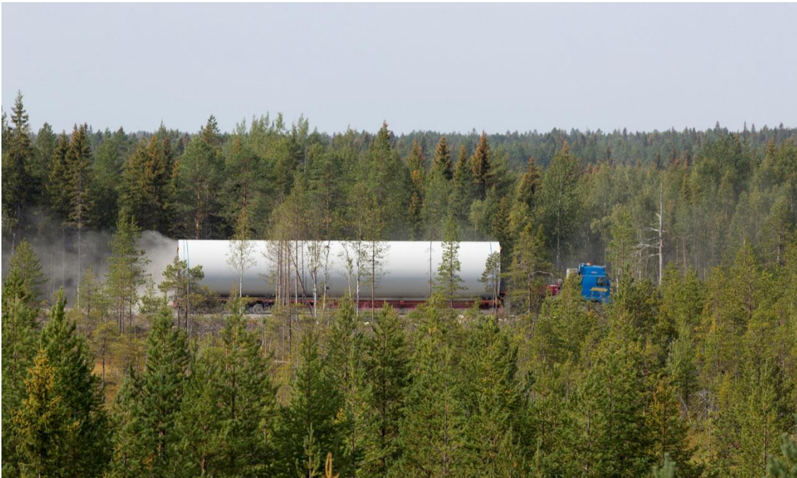
Kuva 4-16. Tuulivoimalan torniosien kuljetusta. (Kuva: Ville Suorsa, FCG).
