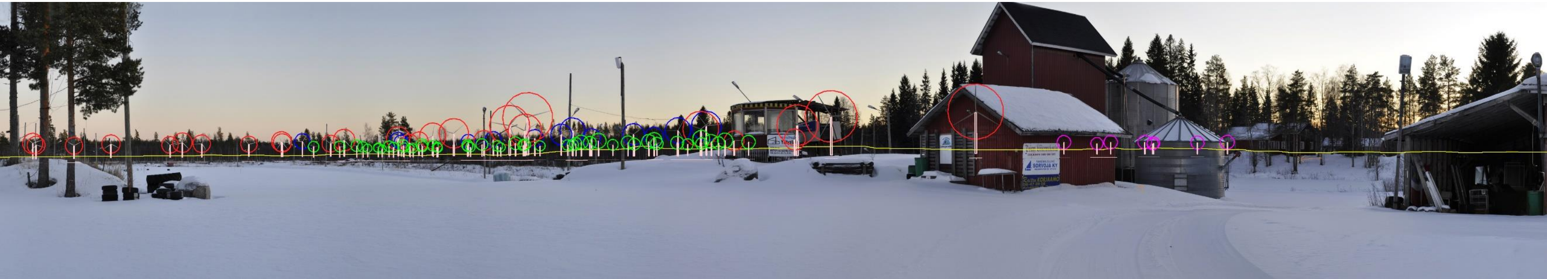
Kuva 106. Kuvauspiste 61, Paratiisi, Draft (VE1). Haapaveden puoleisten voimaloiden roottoriympyrät korostettuna sinisellä ja Oulaisten- punaisella. Puutionsaaren voimalat korostettuna vihreällä ja Tuomiperän voimalat violetilla.
