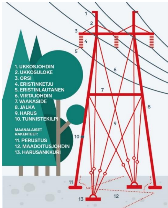
Kuva 3-5. Voimajohdon osat (Fingrid 2021a).
