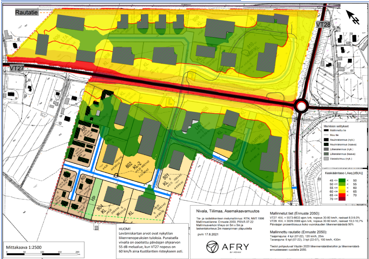
Kuva 13. Tie- ja raiteliikenteen keskiäänitason LAeq leviämiskartta, Ennuste 2050, Päivä 07-22
