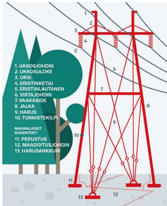
Kuva 3-4. Voimajohdon osat (Fingrid 2021).
